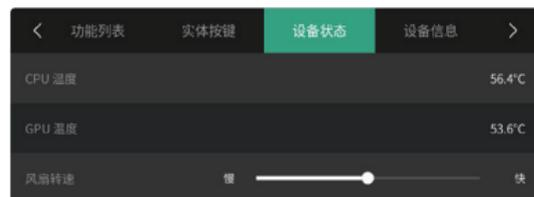
进入该页面可查看设备实时温度并调节风扇转速。风扇支持无级调速，请根据应用场景调整风扇转速。
