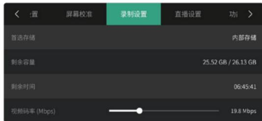
插入 SD 卡或 U 盘后，进入“录制设置”选择录制文件的存储位置。可根据需求设置视频和音频码率、编码类型及录制文件大小。当录制文件达到设定大小上限时，系统将自动创建新文件并继续录制。
