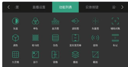
支持快速添加/移除常用功能：点击功能图标即可完成操作，移除后对应快捷按钮将从“常用功能按钮区”中消失。
